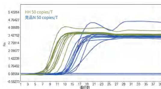
RT-LAMP新冠检测灵敏度可以达到20copies/T，根据定制化要求，最低可以检出样本浓度低至
