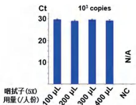
核酸提取试剂盒检测范围适应宽样品量范围，能够实现 400 μL 样本量稳定提取
