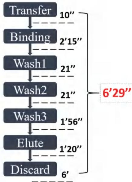
拥有最短的核酸提取时间，仅用时6.5 min就能完成核酸高质量提取。
